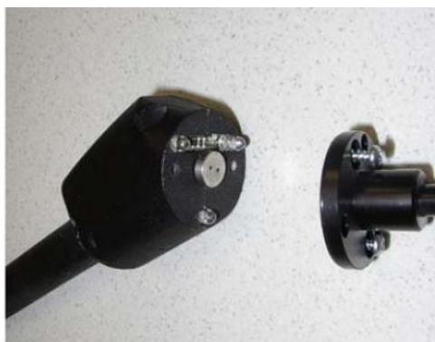
插图 19: 嗅探器手柄中的烧结过滤器
