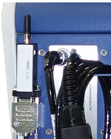
插图 21: 用尼龙搭扣将发射机固定在空闲的地方。
