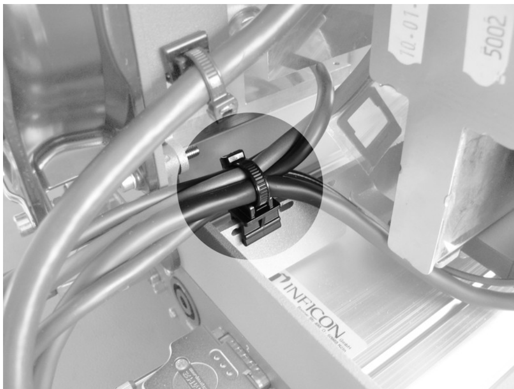
插图 10: 需打开的电缆捆绳
