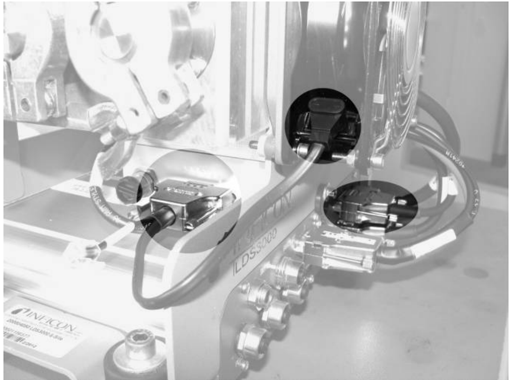
插图 11: 需替换电缆的三个插头
