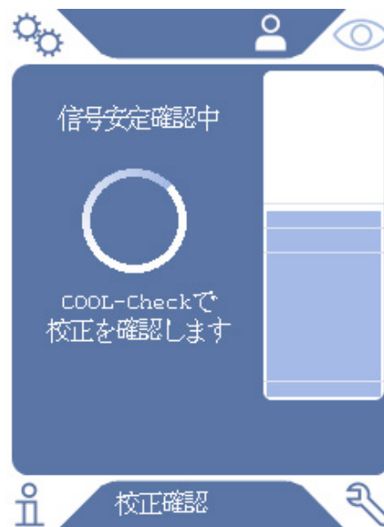
図 12: 内部校正時のディスプレイ表示
