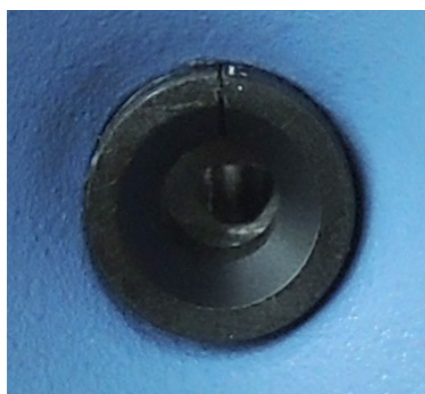
図 10: センターリングの取付け
