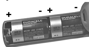
Figura 7. Batterie alcaline installate correttamente
