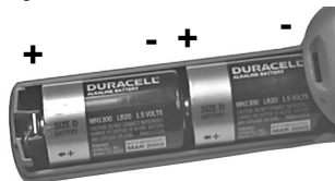
Figura 3. Pilas alcalinas debidamente instaladas
