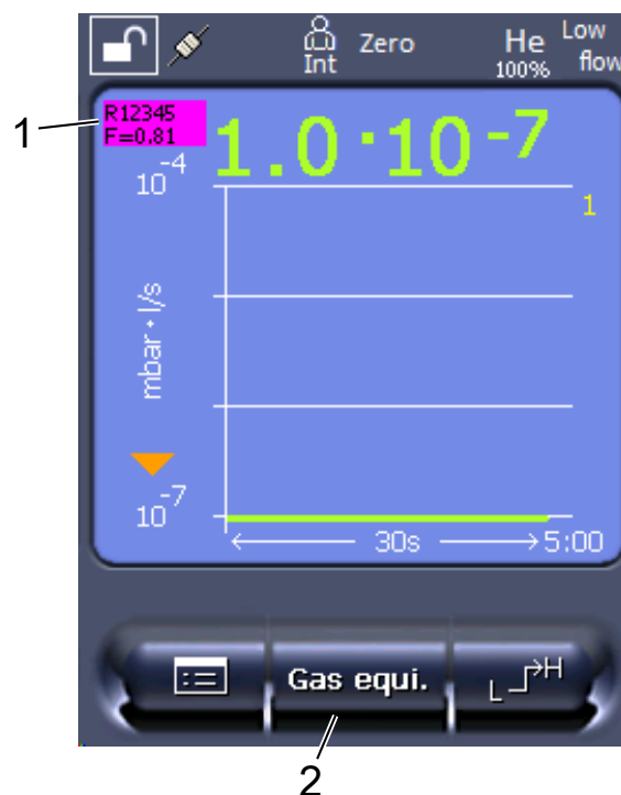
Fig. 7: Écran de mesure avec taux de fuite d'équivalence affiché et touche de favori activée
